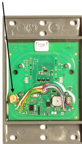
W02 Gehäuse mit RFID Leserelektronik und 5 m Kabel
